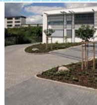
Pavement à joints larges avec déversoir vers un espace vert
